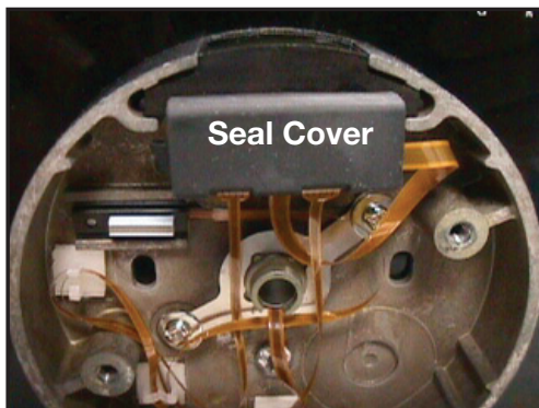
Figure 12 - Open ZIF Seal Cover
